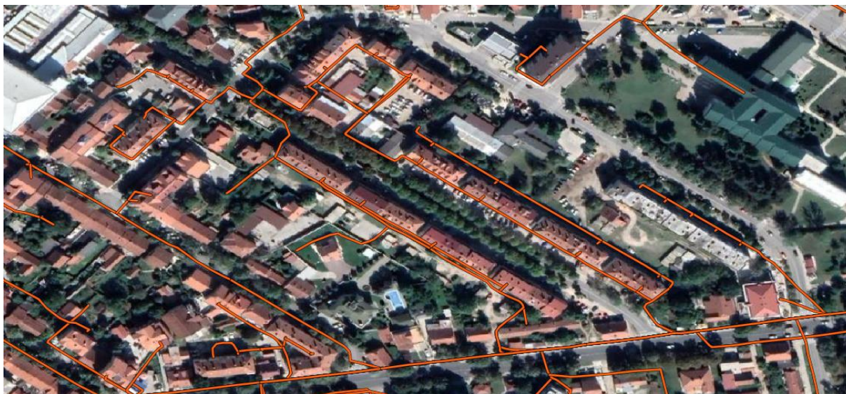
Slika 8: Detaljni prikaz distribucije lokalnih bakarnih kablova
