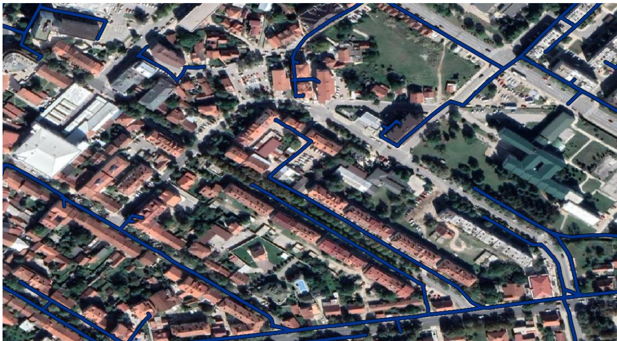
Slika 6: Detaljni prikaz distribucije kablovske kanalizacije
